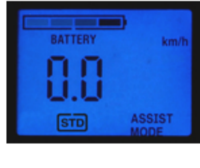
回生充電中はセントラルコントローラの「BATTERY」液晶表示が、左から右に流れるように点滅します。
