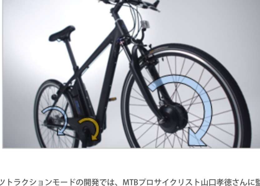
オレンジ色の踏力入力センサーが感知し、前輪はモーターが駆動します。後輪はチェーンを介し人力がそのまま駆動力となります。
