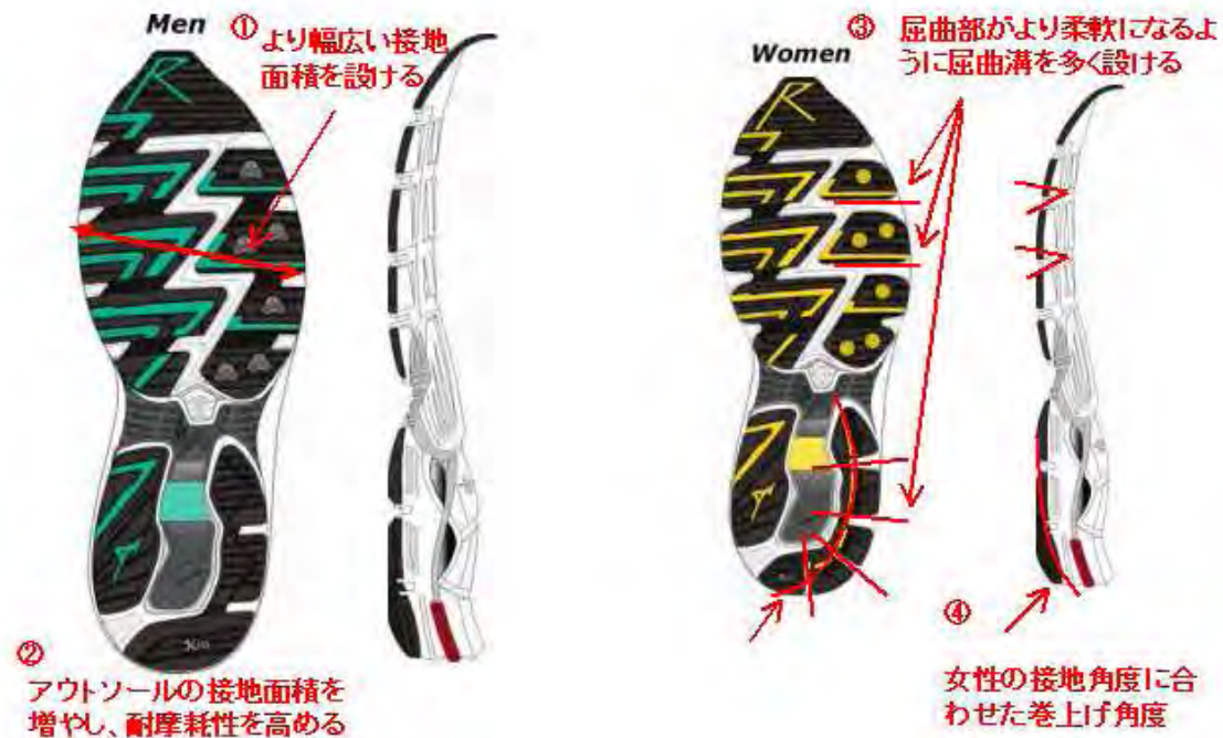
図1：男女によるソール設計の違い（左側：男性用ソール 右側：女性用ソール）
