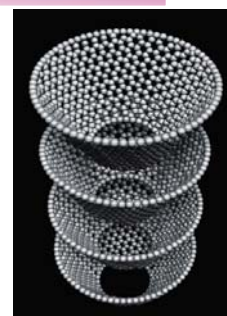
カップスタック型 カーボンナノチューブ 模式図
