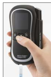
5. 電源ボタンを押して 試験紙を排出
