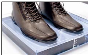
浸水実験の様子
